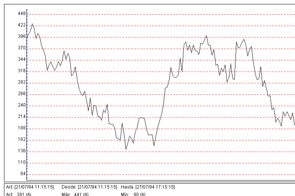
Fig. 5.- Ejemplo de gráfico de una variable (Evolución de la corriente I_1 con el tiempo)
